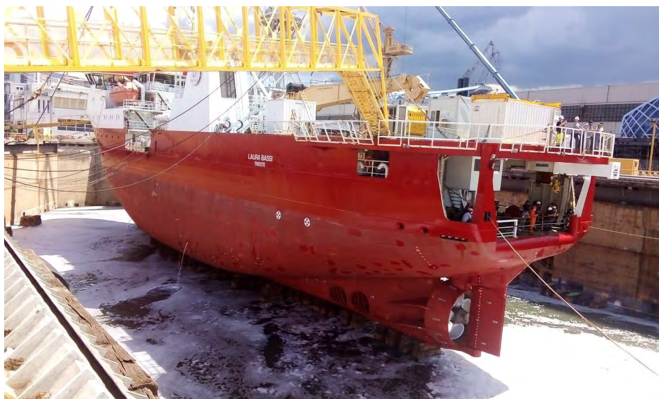
La N/R Laura Bassi a secco, in bacino di carenaggio, subito dopo l'installazione degli strumenti a scafo.
