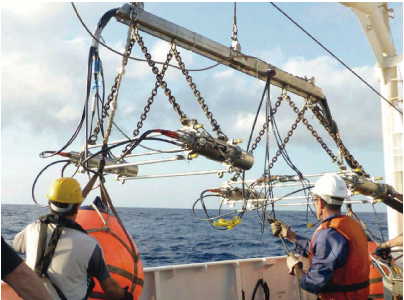
Messa a mare di un array di sorgenti pneumatiche ( airgun ).
