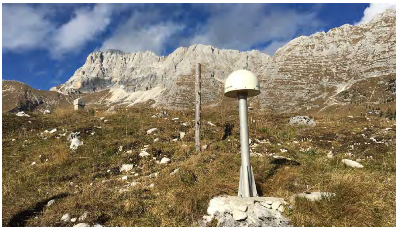
Antenna GNSS della rete SMINO installata sui Piani di Montasio.
