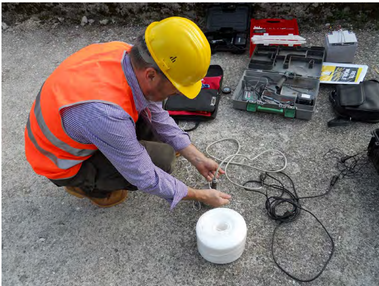
Verifica e calibrazione di apparati di acquisizione sismica.
