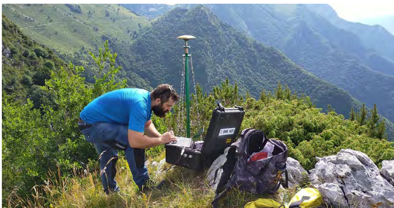
Monitoraggio con sensori GNSS.
