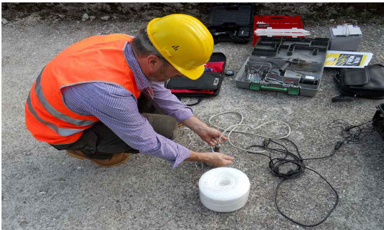
Verifica e calibrazione di apparati di acquisizione sismica.
