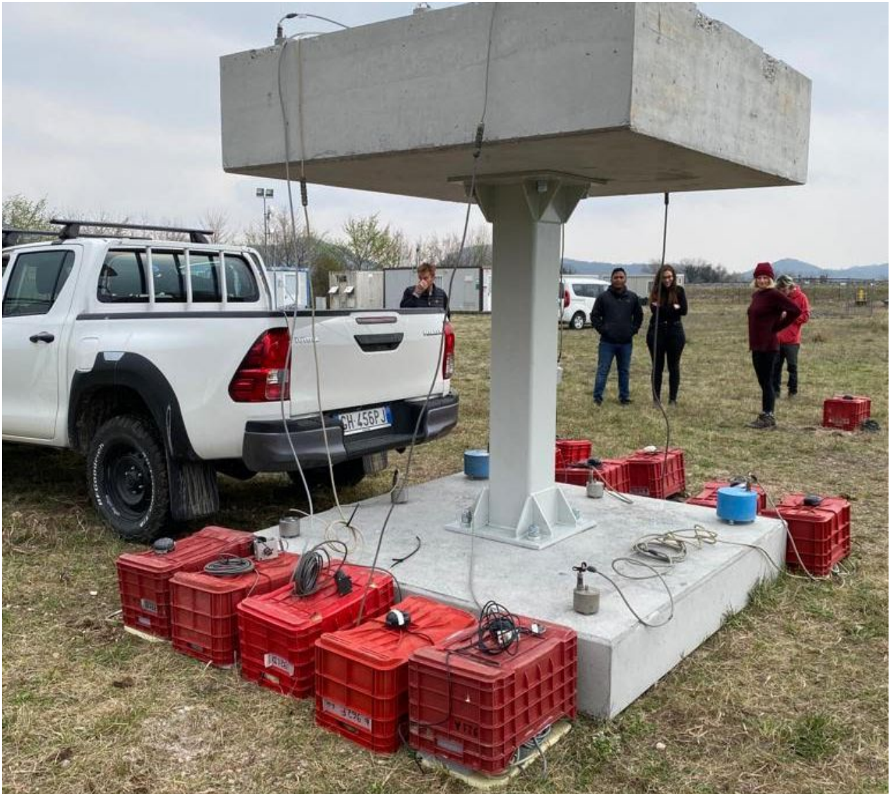
Esperimento per lo studio dell'interazione suolo-struttura.
