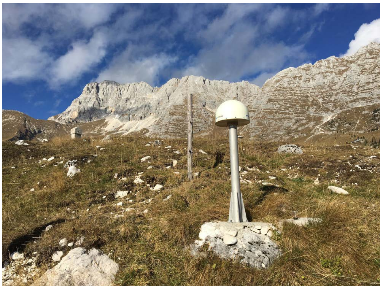
Antenna GNSS della rete SMINO installata sui Piani di Montasio.
