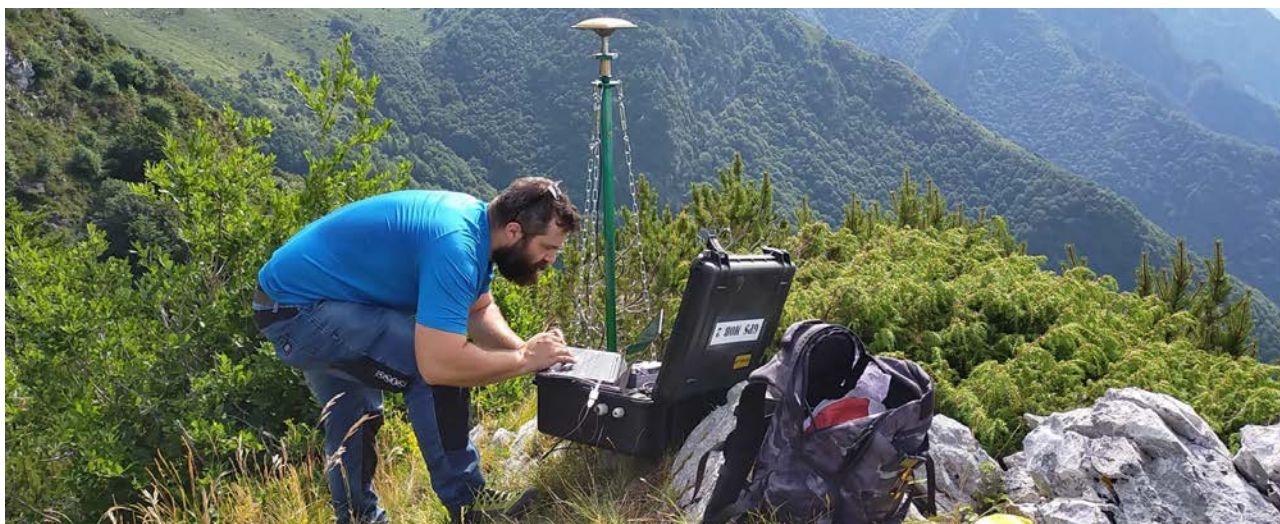
Monitoraggio di frane con sensori GNSS.
