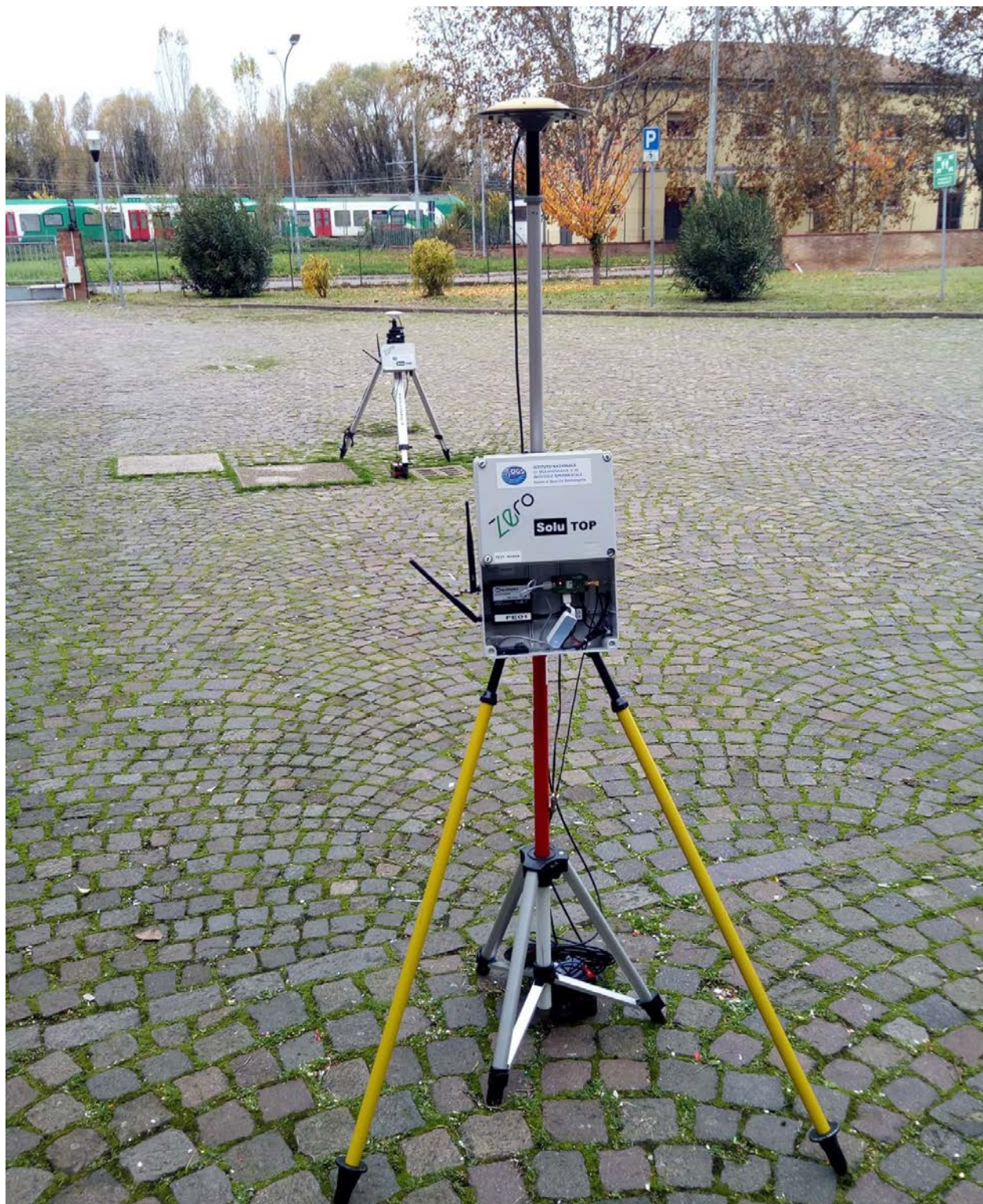
Strumentazione GNSS impiegata per rilievi di campagna.
