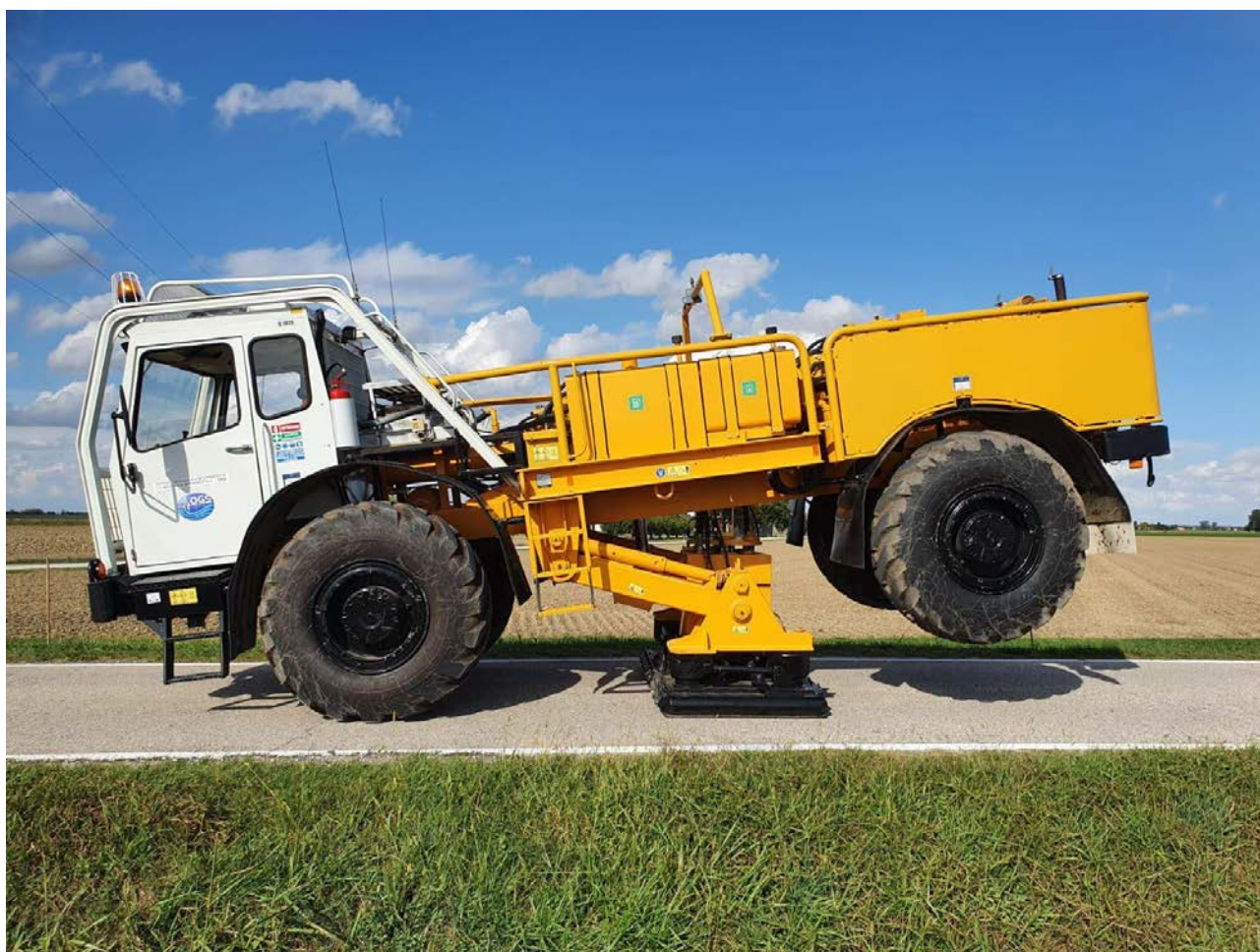
Vibroseis per rilievi sismici.
